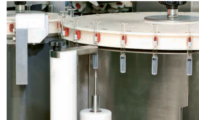
Hochspannung identifiziert Defekte am Nadelschutz zuverlässig, da durch die Leitfähigkeit der heraustretenden Nadel ein Überschlag entsteht. Tests haben gezeigt, dass diese Methode auch die Fehlerstellen bei Spritzen erkennt, bei denen die Nadel von einem festen Plastikschutz (RNS) umgeben ist.
