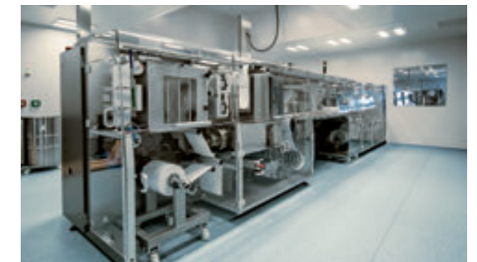
Verpackt 525 Blister pro Minute: komplette Blisterlinie von Mediseal
