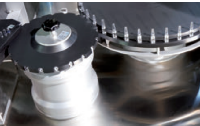
Abb. oben: Vakuumsternräder reduzieren Glasberührungen auf ein Minimum.
