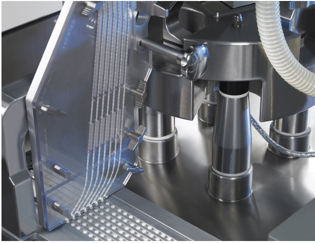
Mediseal Dosierzone: optimiert für die einfache Reinigung.
