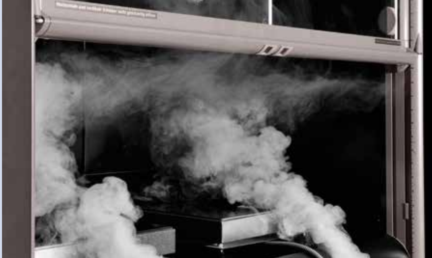
Standardabzug mit Heizquelle
