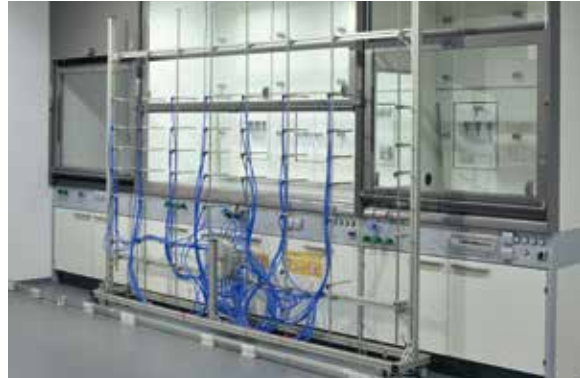
EN 14175-6, typgeprüfte Abzugsregelung nach 5.4 Messung in der äußeren Messebene
