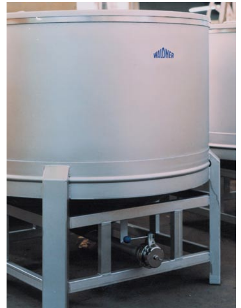
Pufferlagerbehälter mit Flachdeckel
