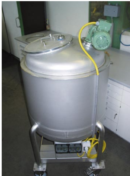
Mobiler Container, mit Rührwerk, Elektro-Heizmatten mit Temperatursteuerung und Isolierung
