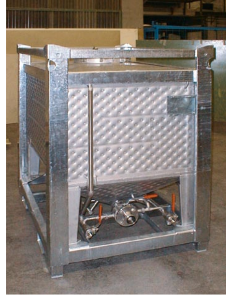
Mit Temperiermantel und Verrohrung für Heißwasser oder Dampf
